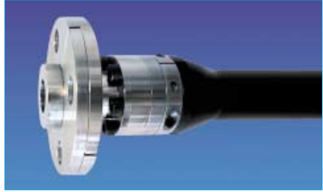
Die Montage der Übergangsstücke am jeweiligen Ende der FLEXWELL-LPG Rohre erfolgt vor Ort auf der Baustelle. Das geht flammlos, d.h. ohne Schweißen oder Hartlöten und ist äußerst einfach. Verwendet werden dazu nur übliche Handwerkzeuge. Die Abdichtung des Innenrohres wird dabei durch die mechanische Verpressung einer gekammerten Graphitdichtung erzielt. Für die Anbindung an übliche Stahlrohre sind die Verbindungsteile mit einem NPT-Außengewinde oder alternativ mit Bund und passenden geteilten Losflanschen erhältlich.
